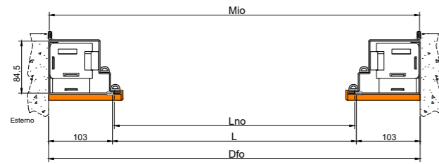
SEZIONE ORIZZONTALE HORIZONTAL SECTION
