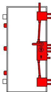
Serratura di sicurezza per cilindro a Profilo Europeo e serratura di servizio con cilindro. Versioni standard e su misura ad uno o due battenti.
