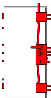
Serratura di sicurezza per cilindro a Profilo Europeo e serratura di servizio con cilindro.
