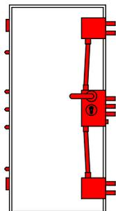
Serratura di sicurezza per cilindro a Profilo Europeo. Versioni standard e su misura ad una o due battenti.
